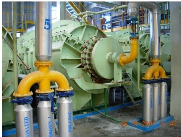
Gambar 4.18. Filter Press untuk Carbonated Liquor
