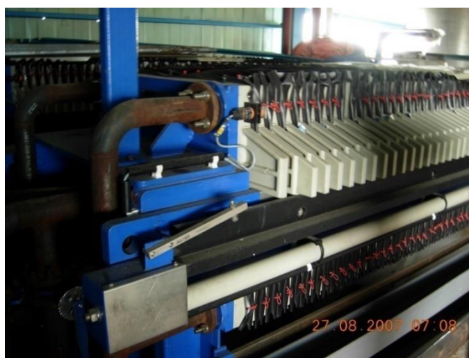
Gambar 4.19. De-sweetening dengan Filter Press
