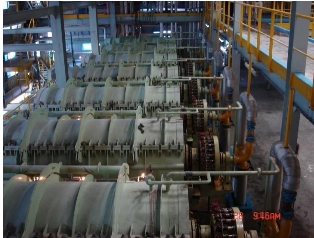
Gambar 4.17. Saringan tekan untuk carbonated liquor
