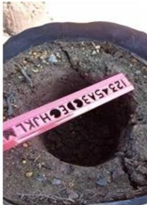
**Gambar 11.** Pengukuran diameter T-PLANT yaitu 11 cm
