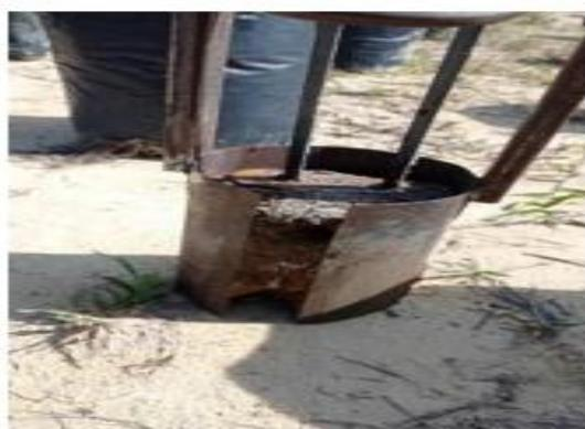
**Gambar 10.** Tanah yang terangkat sesuai dengan ukuran alat
