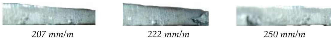
Gambar 5. Hasil visual pemotongan baja 5 mm
