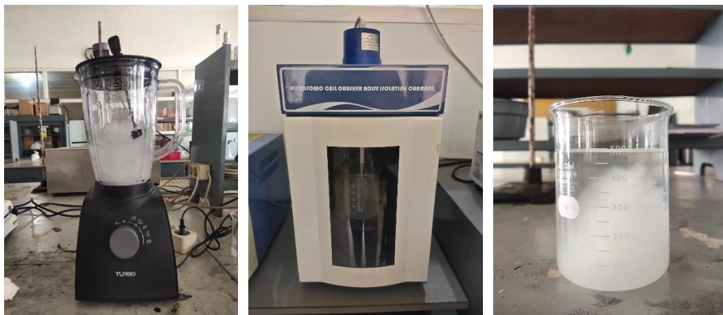
Gambar 9. Proses Blending dan Ultrasonikasi
