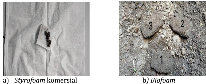
Gambar 4. Kondisi Styrofoam Komersial dan Biofoam Sampel 1, 2, dan 3 setelah 10 Hari Pemendaman di Dalam Tanah
